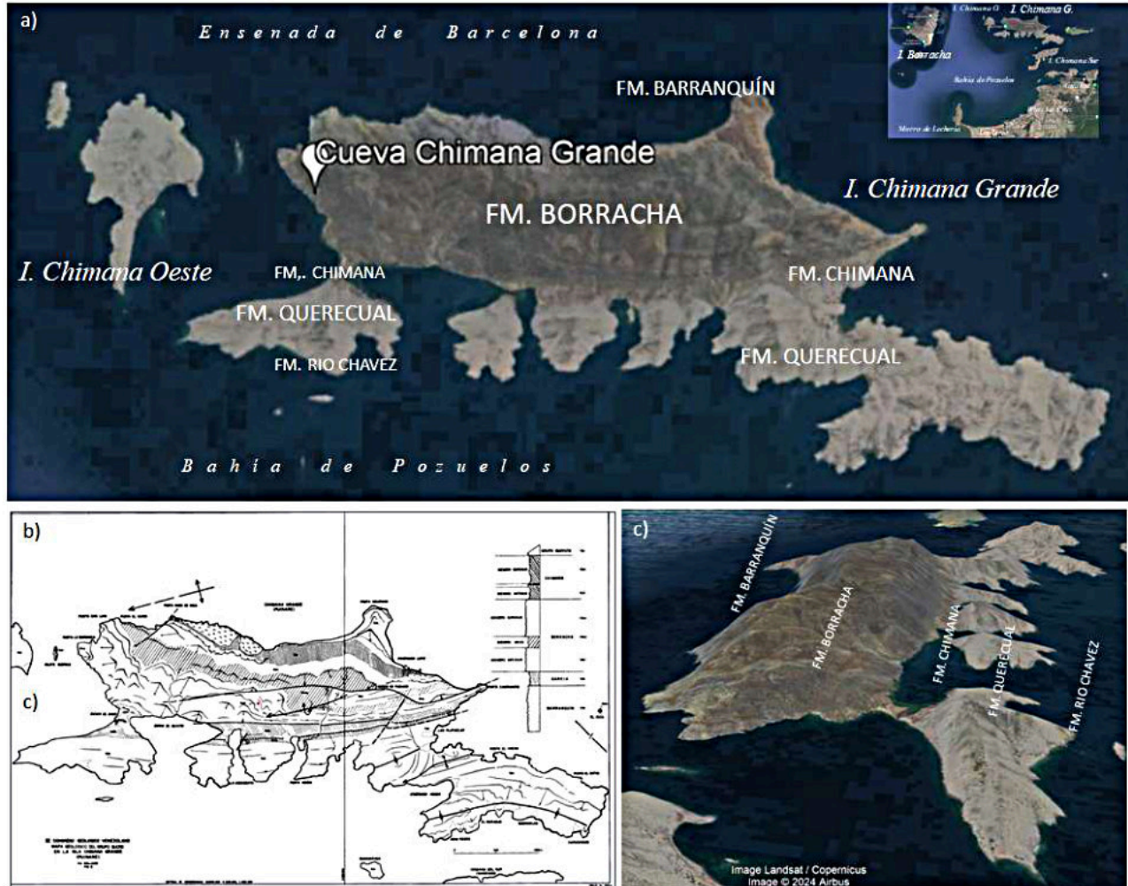
Figura 3. a) imagen satelital de Google Earth, observando la variación en color de las unidades litoestratigráficas que afloran en la isla b) mapa geológico de la isla (Guillaume et al. , 1972) c) imagen 3D de Google Earth donde se observa un paralelismo entre las unidades litoestratigráficas y el relieve topográfico de la isla.
